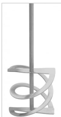
Due eliche inclinate a destra per impastare e mescolare materiali ad elevata viscosità e pastosi. L'elica si immerge nel materiale e lo spinge verso l'alto. Modello versatile per: colle per piastrelle, stucchi per giunti, stucchi, intonaco pronto, intonaco adesivo, masse di livellazione, pavimenti.
